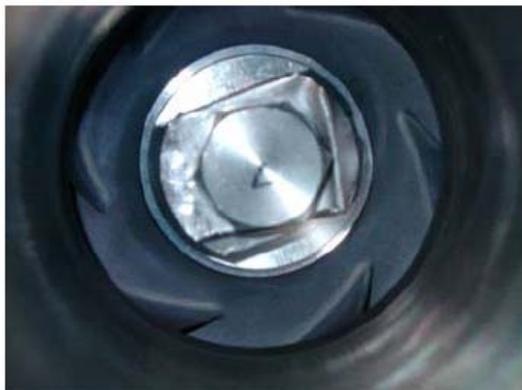
Потом согните предохранительную шайбу болта рабочего колеса и закрепите её.
