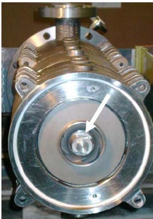
Входной корпус снят. Отогните стопорную шайбу гайки вала.
