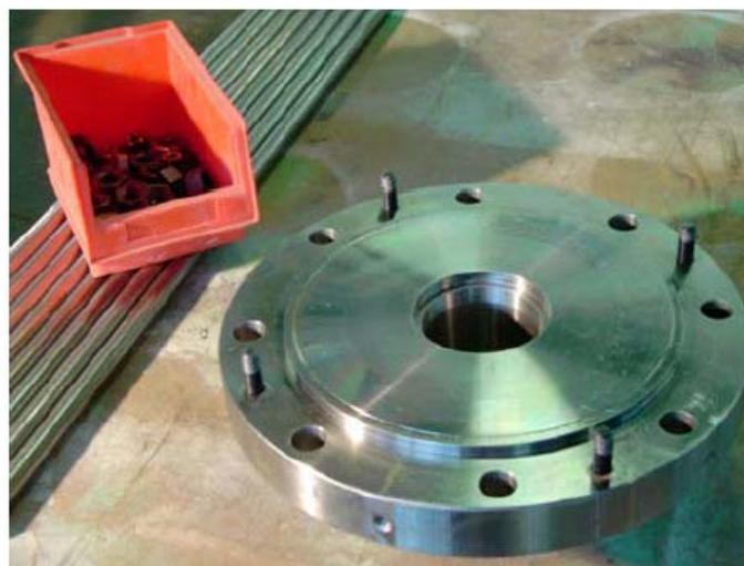
Демонтированный входной корпус
