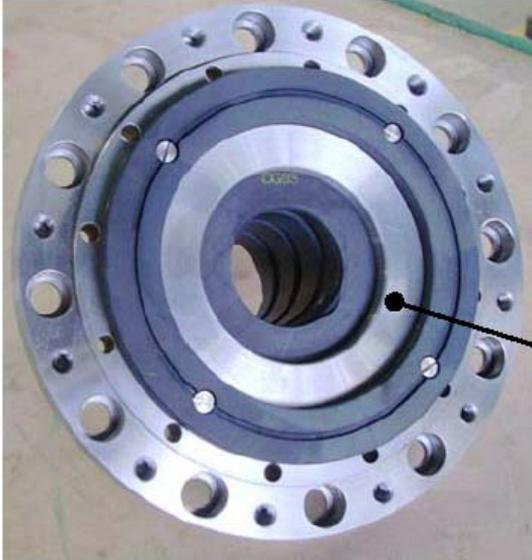
Задний осевой подшипник к переднему корпусу двигателя прикреплен винтами, и его можно снять, выворачивая эти винты.
